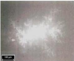
Des zones de faible densification peuvent apparaître dans les matériaux en céramique. Ce sont des zones au niveau desquelles la densité de matière est plus faible que pour le reste de la bille.
