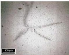
Des fissures peuvent être provoquées par un non respect des températures lors du déliantage de la céramique ou du refroidissement du métal. Dans le cas de la céramique, nous parlerons de fissures de déliantage et de criques ou de tapures pour l'acier.
