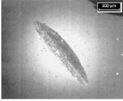
L'entaille est une abrasion mécanique due à un outil d'usinage. Elle peut avoir des dimensions importantes en fonction de l'outil à l'origine de sa formation. Elle peut être présente sur l'acier et la céramique.
