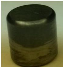
Un usinage mal paramétré peut engendrer une brûlure ou une surchauffe. Ce défaut provoque une modification locale de la structure de l'acier. Ce défaut peut être mis en évidence par une attaque chimique (Nital ou Niteau).
