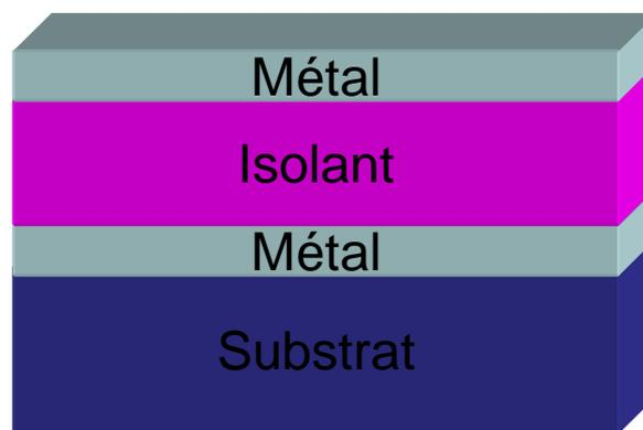
*Figure 2-11 : Vue schématique de la structure finale de nos couches minces 'Structure Métal/Isolant/Métal'*
