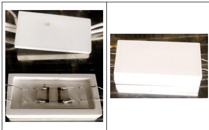
Figure 5-12 : Encapsulation du capteur SAW d'humidité
