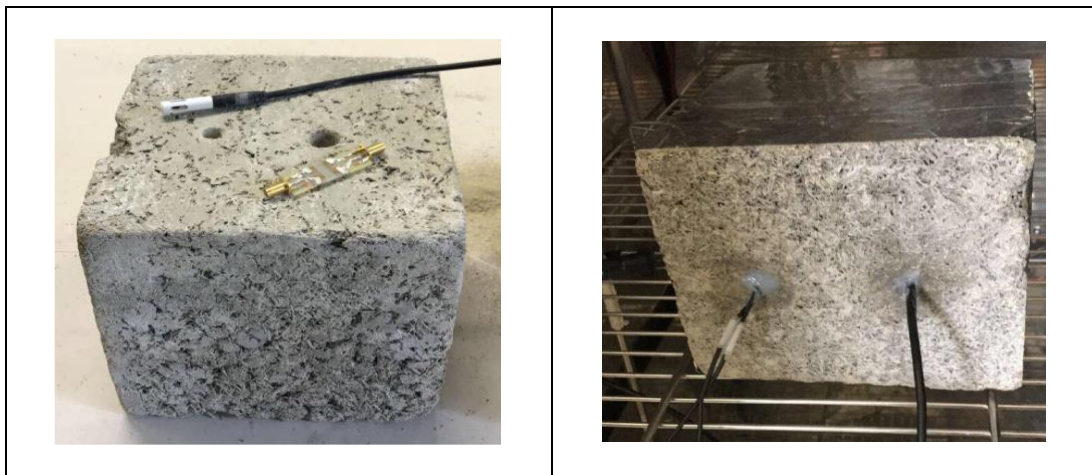
Figure 5-4 : Bloc de béton de lin pour les essais dans le béton génie civil
