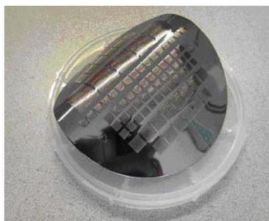
Figure 7.13 : Photographie d'un wafer déformé par la contrainte liée à l'oxydation du silicium poreux [Yalal-aithammouda, 2007].
