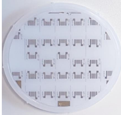
Figure 3.15 : Wafer de \text{LiNbO}_3 sur lequel a été déposée des électrodes en or.
