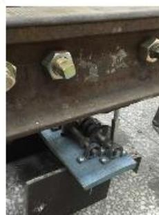
**[ZHA 17c] Récupérateur électromagnétique avec un système d'engrenage (vibrations des rails).** La tension maximale est de 58V à 1Hz avec une résistance de 3 $\Omega$  pour un déplacement de 2.5mm.
