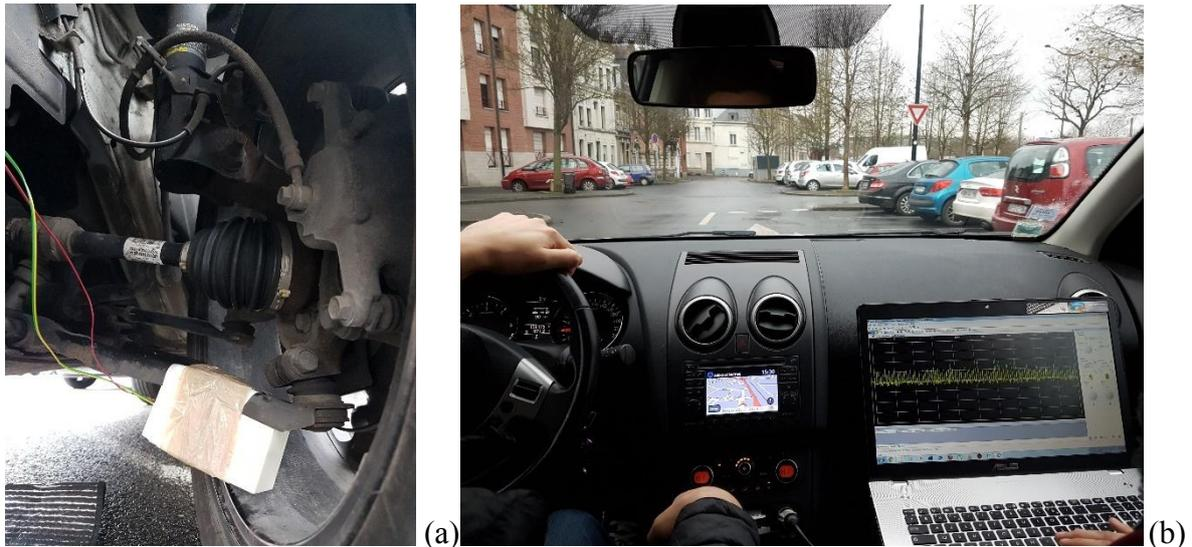
**Figure 5.24** Poutre piézoélectrique attachée à la masse non-suspendue d'une voiture (a). Des tests ont été réalisés pour plusieurs vitesses de véhicule (b)
