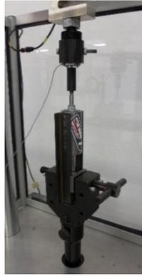
**Figure 4.9 Prototype n°3 du convertisseur électromagnétique intégré dans le corps d'un amortisseur**
